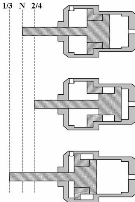
Ce piston de commande de passage de vitesses à trois positions est enclenché pneumatiquement.
