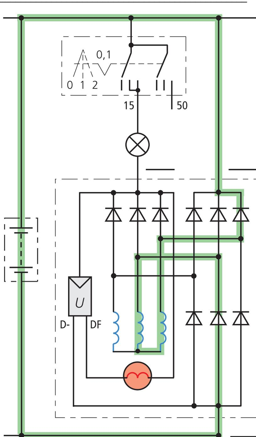
d) Colorier en bleu toutes les diodes de puissance positives présentes sur le schéma.
