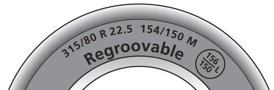
**Le chiffre 156 représente la charge maximale d'un pneumatique ...**
