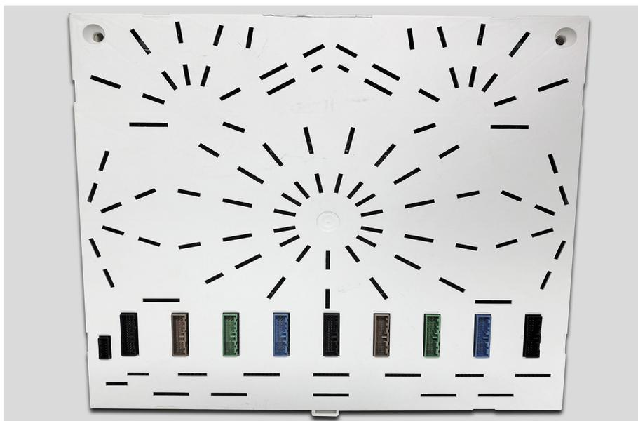
Fig. 2: l'unità di controllo J497 di VW (con le fessure di raffreddamento nell'alloggiamento in plastica) è l'unità di controllo principale per il monitoraggio dei moduli delle batterie. Essa riceve i valori di tensione delle celle e la temperatura dei moduli attraverso il collegamento di linea specifico (spine colorate) e avvia il bilanciamento.
