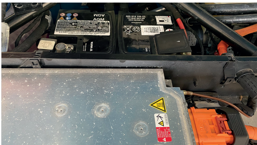
Fig. 1: l'Audi e-tron si affida a una grande batteria AGM per l'impianto elettrico a 12 V.
