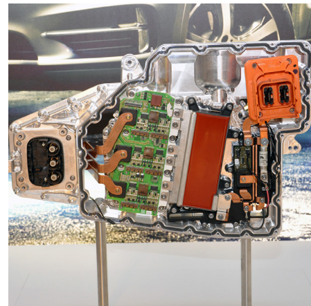
Die Leistungselektronik des BMW X5 verarbeitet eine Spannungsbreite von 240 - 410 V und einen maximalen Phasenstrom von 450 A.
