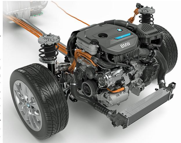
Vorderradantriebseinheit mit Starter-Generator und Klimakompressor.
