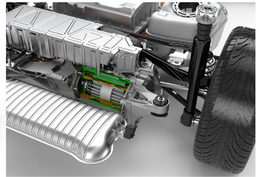
Zwischen der Leistungselektronik und dem Benzin tank ist die (geschnittene) E-Maschine zu erkennen.
