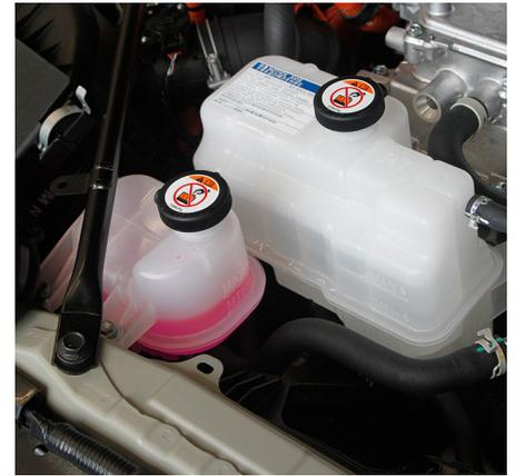
Il colore del liquido di raffreddamento rivela i due circuiti: alla Toyota, il refrigerante per i componenti AV è rosa, mentre il refrigerante speciale per la parte delle celle a combustibile è chiaro e trasparente. Se il liquido di raffreddamento delle FC è miscelato con altri fluidi o con l'acqua, solo un costoso e lungo lavaggio dell'impianto può essere d'aiuto.
