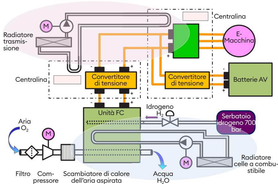
La gestione termica di un veicolo a celle a combustibile si divide almeno in due parti. I componenti del sistema ad alta tensione e della cella a combustibile sono raffreddati separatamente.
