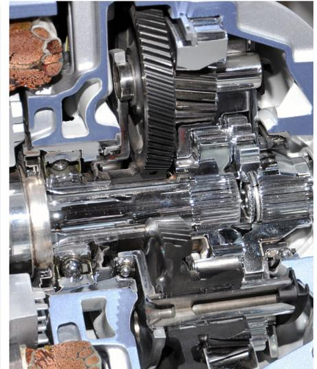
Getriebe und Kurzbaudifferenzial aus dem Audi e-tron
