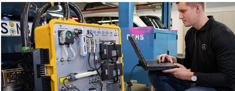
Die Strassenemissionen werden mit einem portablen Emissionsmessgerät (PEMS) erfasst.
