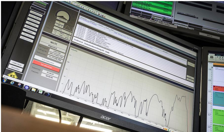
Bei der Prüfstands-messung werden die Fahrzeuge nach dem WLTP-Zyklus bewegt. Die Stillstandsphasen sind Motivation, ein Start-Stopp-System zu integrieren (Mild-Hybrid). Je geringer der Verbrauch beim Verbrenner, desto kleiner auch die CO<sub>2</sub>-Emissionen nach Norm.
