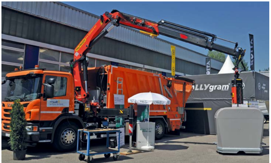
Système de pesage mobile sur grue, ici pour un conteneur enterré.
