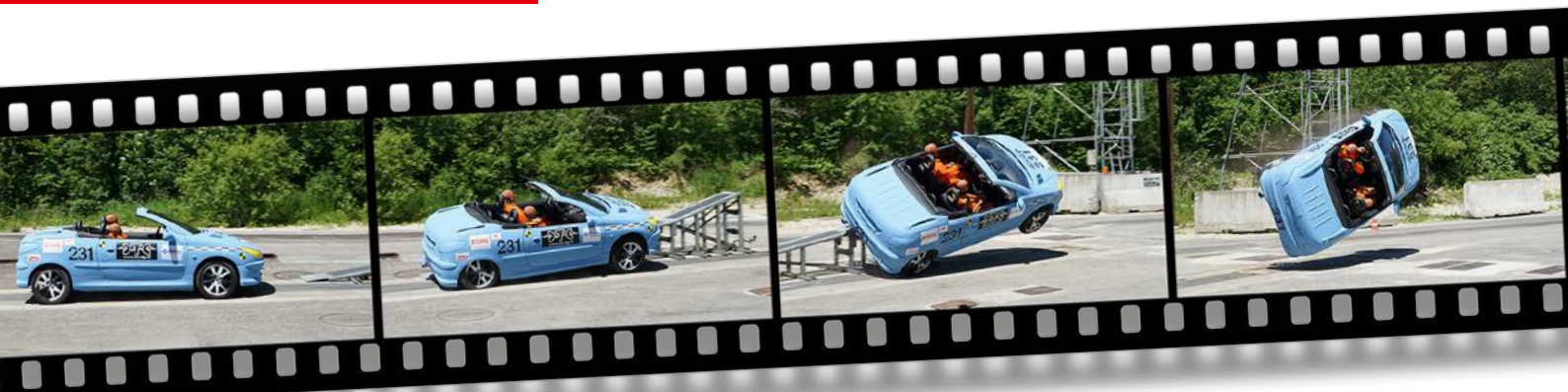
Différentes phases et résultat final du « Corkscrew Rollover Cabriolet ».
