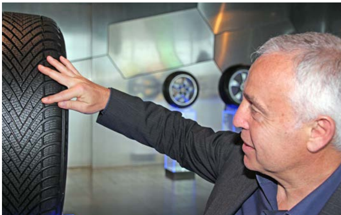
Giuseppe Matrascia montre les rainures à drainage accéléré qui améliorent le comportement du pneu en matière d'aquaplaning.
