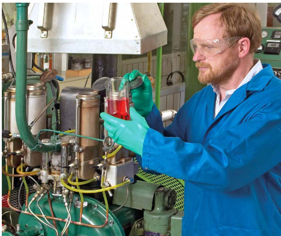
Fig. 1 : Le moteur expérimental CFR permettant de déterminer l'indice d'octane.
