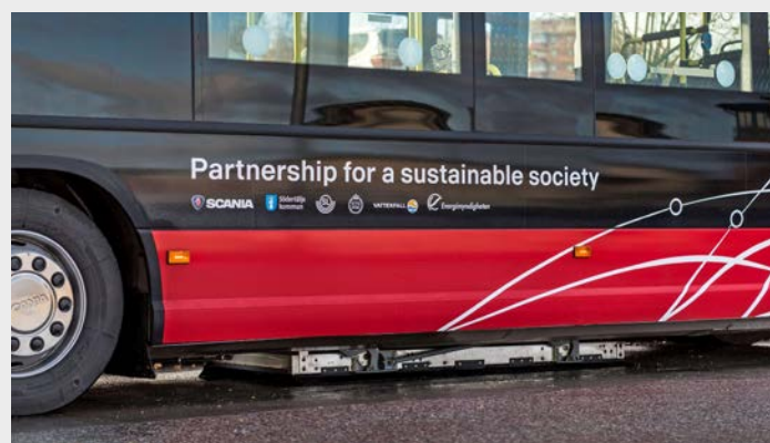
Recharge de batterie à l'arrêt de bus : Scania teste un système inductif.
