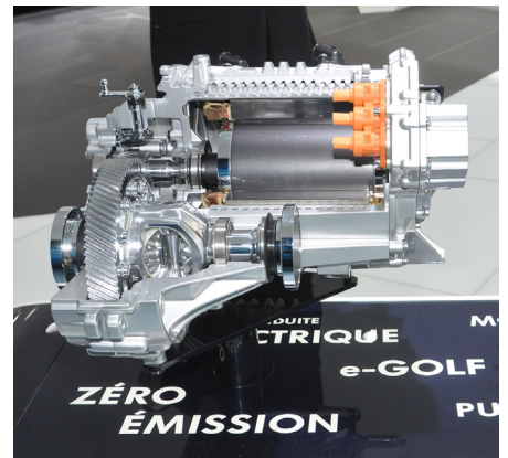
Fig. 2: molti motori di trazione nella trasmissione hanno magneti interrati (sepolti) e assomigliano a macchine a poli interi.
