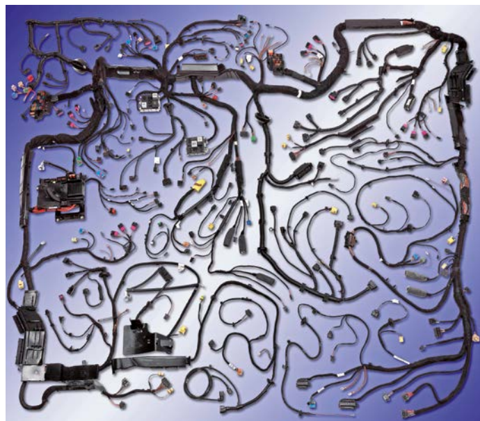
Bild 1. Ein Kabelstrang eines Oberklassefahrzeugs wiegt circa 45 Kilogramm und besteht aus bis zu 3 Kilometern elektrischer Leitungen. Aber selbst einfache Ausführungen weisen noch eine Gesamtlänge von 1,5 Kilometer auf und bringen gegen 20 Kilogramm auf die Waage.
